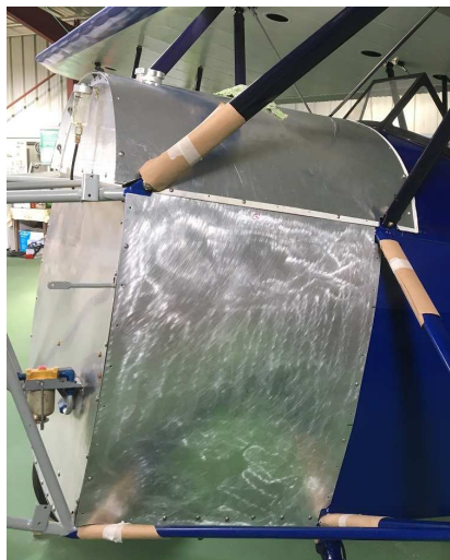
Mai 2020. Le plastron et les capots métalliques sont positionnés avant d'être démontés pour peinture.
