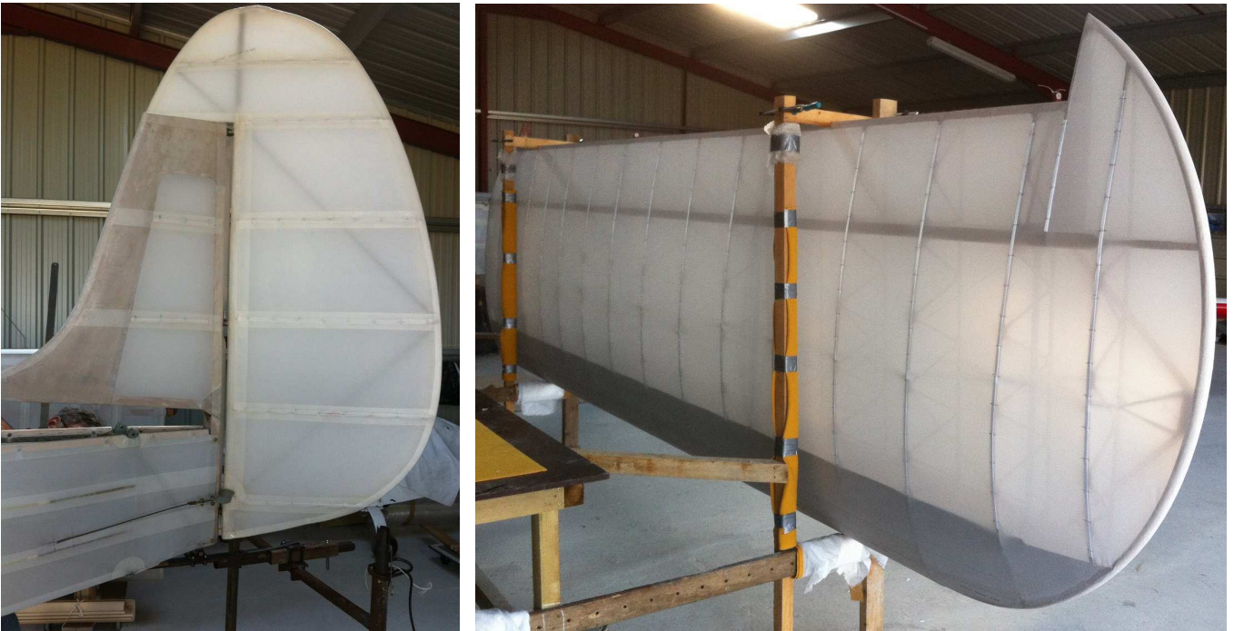
Janvier et février 2019 : entoilage, lardage, pose de bandes de renfort ; tout ce qu'il faut pour l'enveloppe de la structure...
