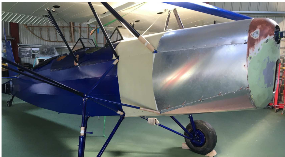
Mai 2020. Le plastron et les capots métalliques sont positionnés avant d'être démontés pour peinture.
