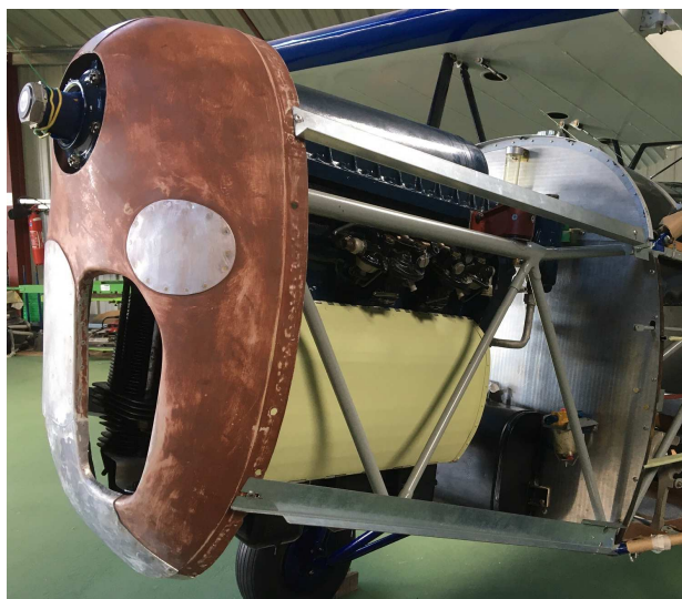
Septembre 2019. Le moteur est en place après un minutieux travail sur le plastron pour inverser l'entrée d'air.
