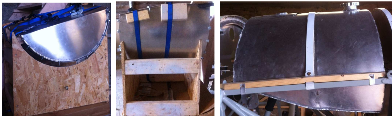
Juillet 2016. Détails de la fabrication du réservoir de carburant (celui d'huile a juste été réparé).
