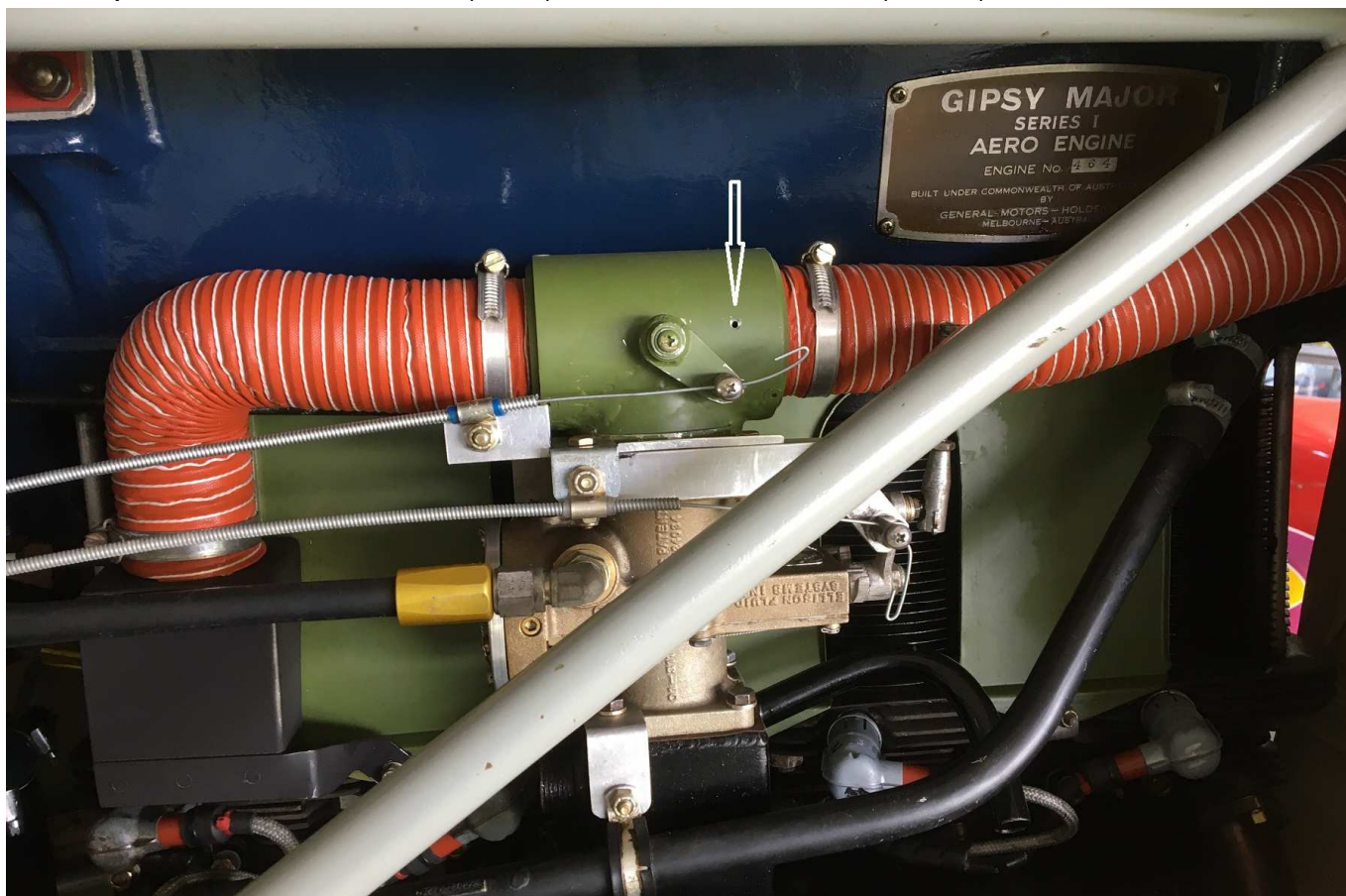
Septembre 2019. Le moteur est en place après un minutieux travail sur le plastron pour inverser l'entrée d'air.
