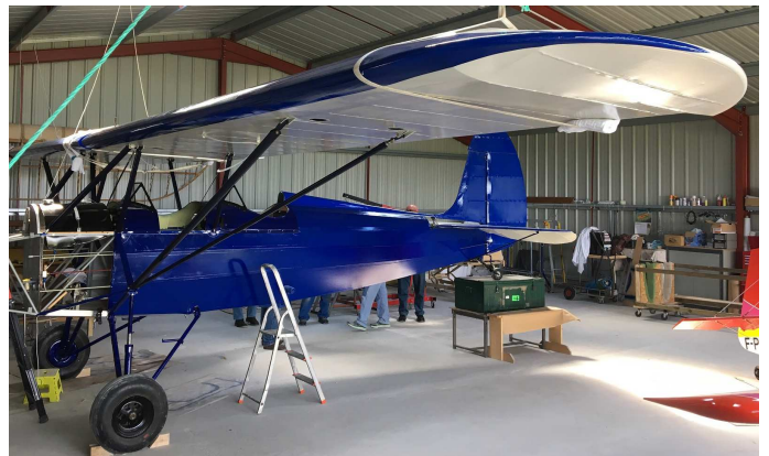
Mars et avril 2019 : peinture de la cellule en duo puis installation des ailes avec des cordages s'appuyant sur des poulies.
