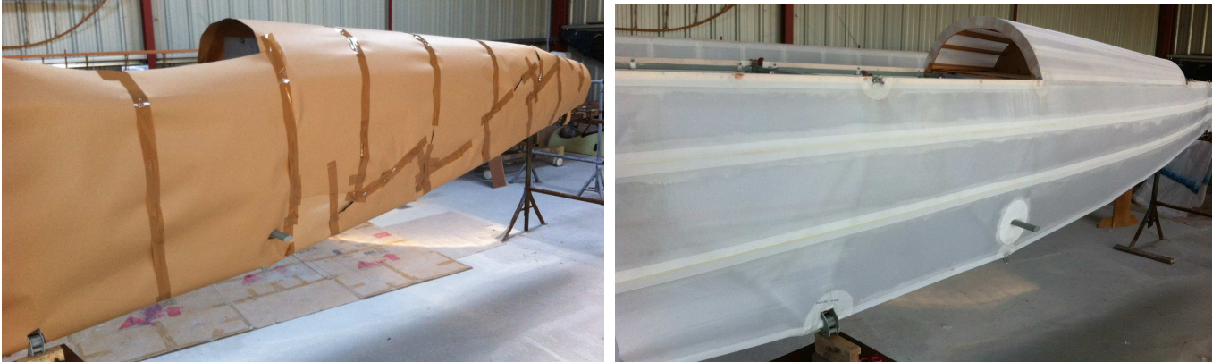
Janvier et février 2019 : entoilage, lardage, pose de bandes de renfort ; tout ce qu'il faut pour l'enveloppe de la structure...
