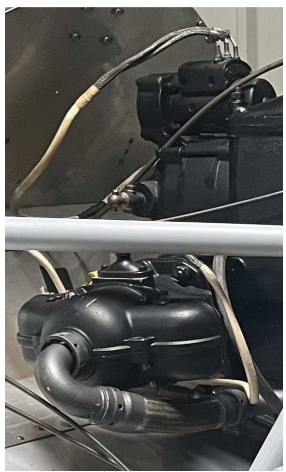
Ci-dessus, le carburateur avec ses deux entrées d'air (frais ou chaud) ; ci-contre, le démarreur à inertie et la magnéto ; à droite, le moteur doté de son hélice (avec sa casserole pour le plaisir) et la bache à huile (orifice ouvert) qui va engloutir le lubrifiant.
