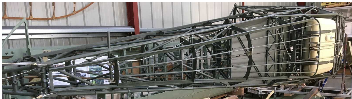
Été 2022 : la structure du fuselage a été sablée puis peinte. Les câbles des gouvernes passant dessous, le réservoir est mis en place.
