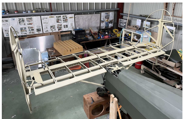
Empennage monté « à blanc » pour essai avant entoilage.
