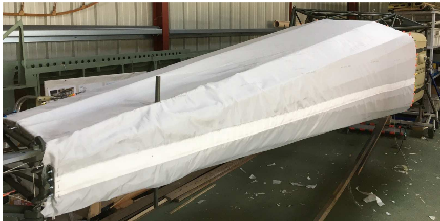
Été 2022 : un coup de fer à repasser et la toile sera tendue sur l'arrière de la structure.
