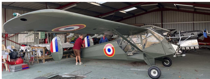
L'aile droite est montée et la gauche suivra après un demi-tour de l'avion
