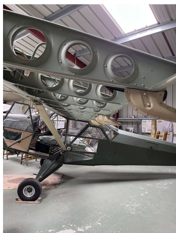
Montage "à blanc" de l'aile gauche
