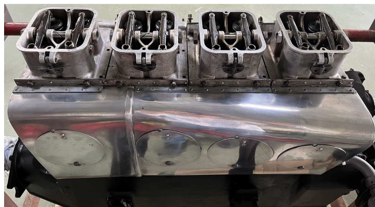
Septembre 2023 : culbuteurs réglés afin que toutes les soupapes ferment.
