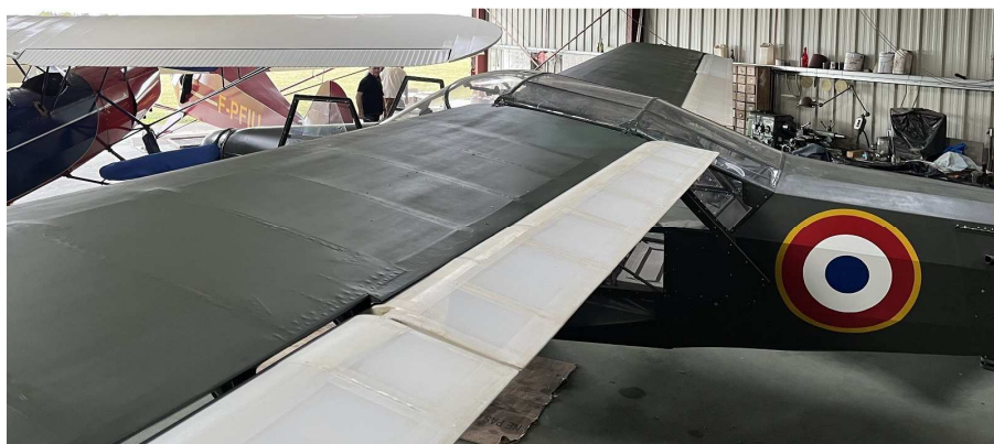
Pas encore peints, les volets et ailerons sont positionnés pour régler leurs débattements.
